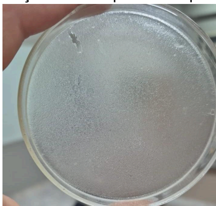
Figura 1- Formação do filme polimérico por solvent casting
