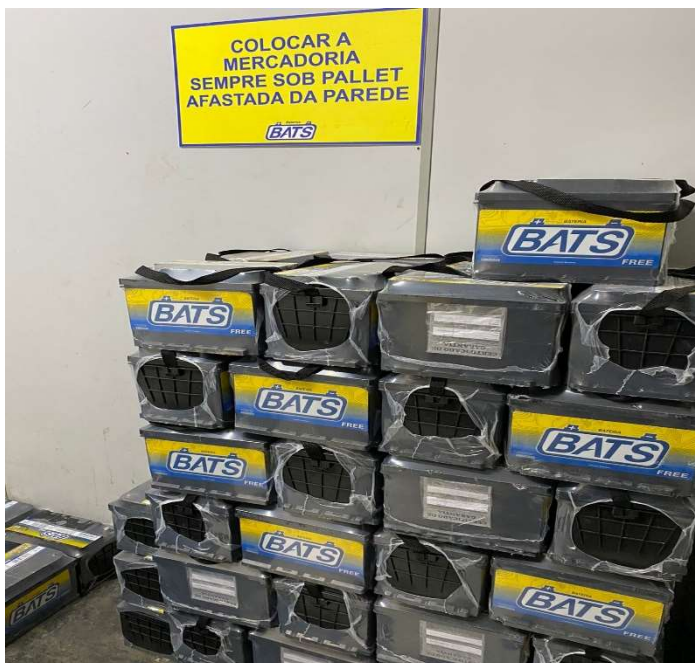
Figura 2 Armazenamento adequado das baterias. Fonte: produzida pelo autor.
