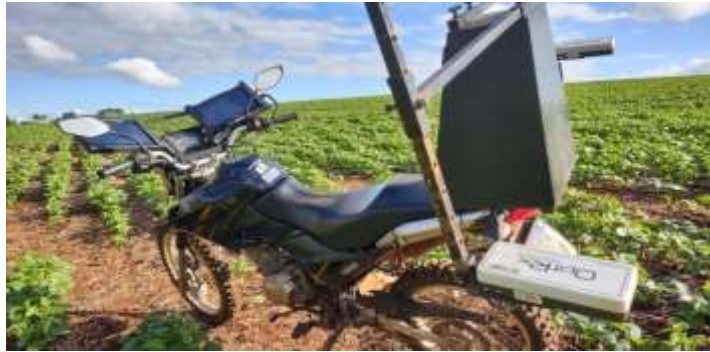
Figura 1. Equipamento Ag Leader OptRx para leitura do NDVI.
