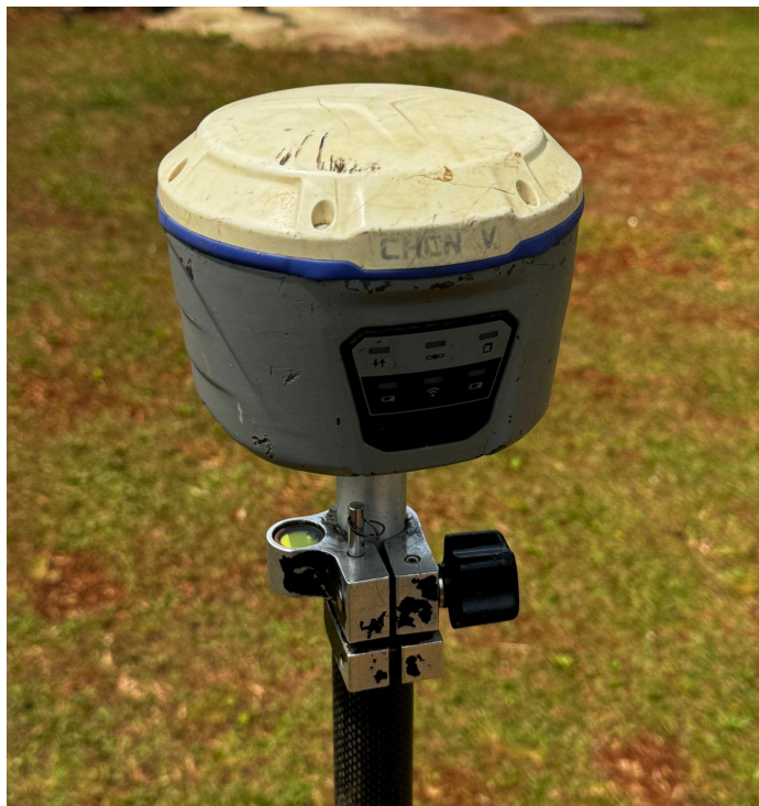
Figura 4 - Aparelho geodésico, modelo CHCNAV I50:
