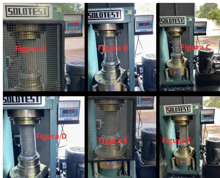
Figura 3 - Ensaio de resistência à compressão.
