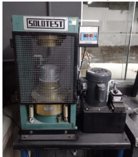
Figura 7: Prensa hidráulica utilizada para rompimento
