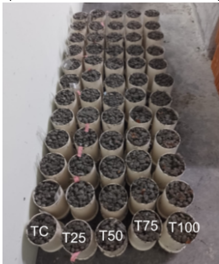
Figura 6: 60 Corpos de Prova cilíndricos, sendo 12 para cada traço.
