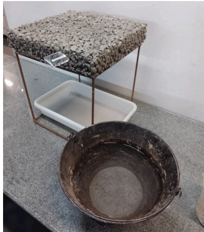
Figura 8: Estrutura teste de permeabilidade
