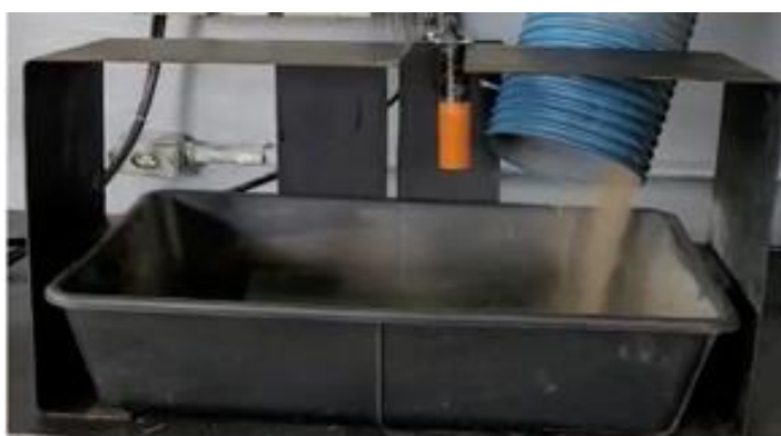
Figura 17 - Teste de acionamento do sensor de nível.
