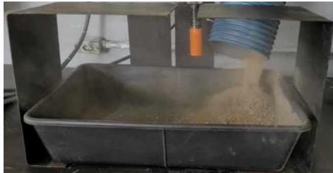
Figura 18 - Teste de acionamento do sensor de nível.
