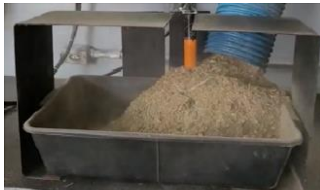
Figura 19 - Teste de acionamento do sensor de nível.
