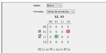
Para construção das tabelas 3 e 4 e as figuras 9 e 10 foi utilizado o software LOGISIM® 2.7.1 versão gratuita. A figura 11 apresenta a expressão reduzida para o sistema da lógica do braço e a figura 12 apresenta a expressão reduzida para o sistema da lógica da barra.
