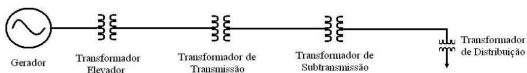
Figura 2 - Sistema básico de transmissão de energia elétrica
