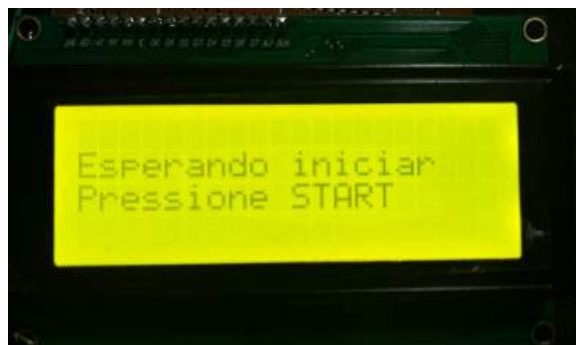
Figura 4 - Teste da versão final do protótipo ainda em laboratório, demonstrando a interface ao ligar a energia
