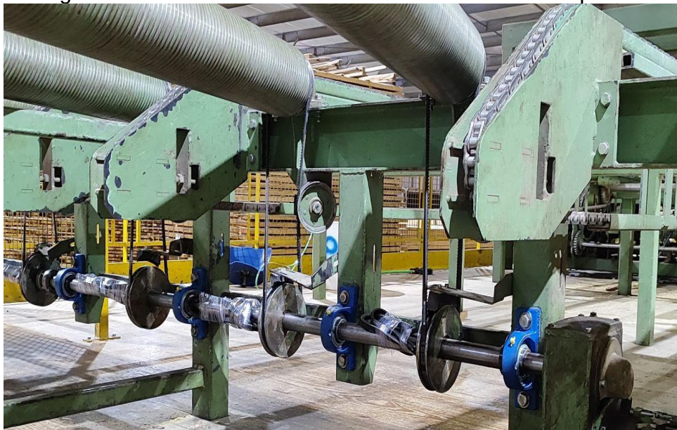
Figura 3 - Correias de acionamento dos rolos de transporte
