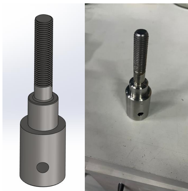
Figura4 – Cátodo Dimensionado e Fabricado em Inox 304.
