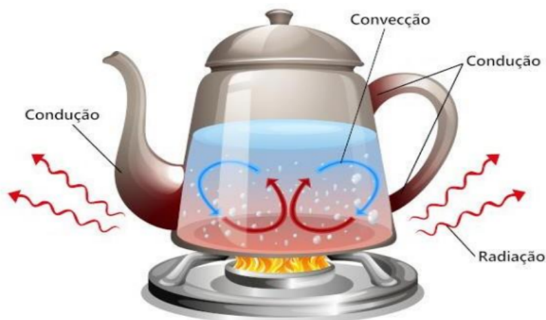
Figura 1 - Representação esquemática dos mecanismos de transferência de calor.
