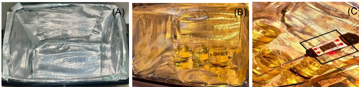
Figura 4 - (A) caixa térmica revestida com manta térmica; (B) amostras submersas no óleo; (C) temperatura interna 42,5°C
