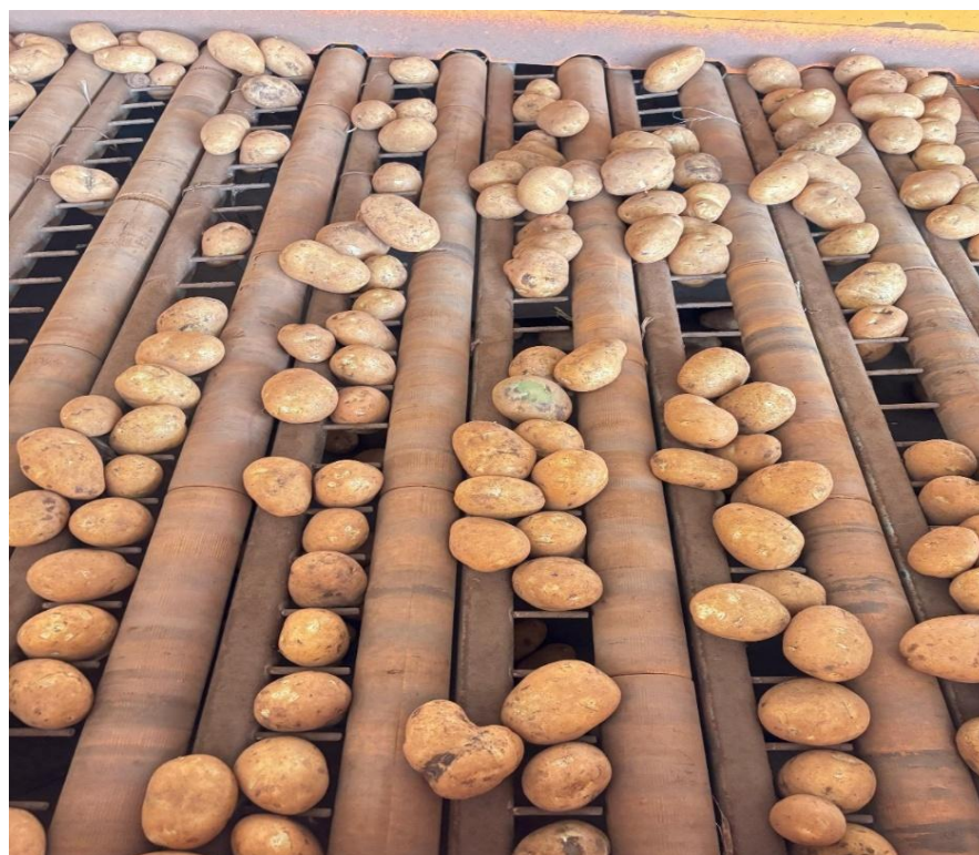
Figura 3 – Imagem de como ocorre a separação das sementes.
