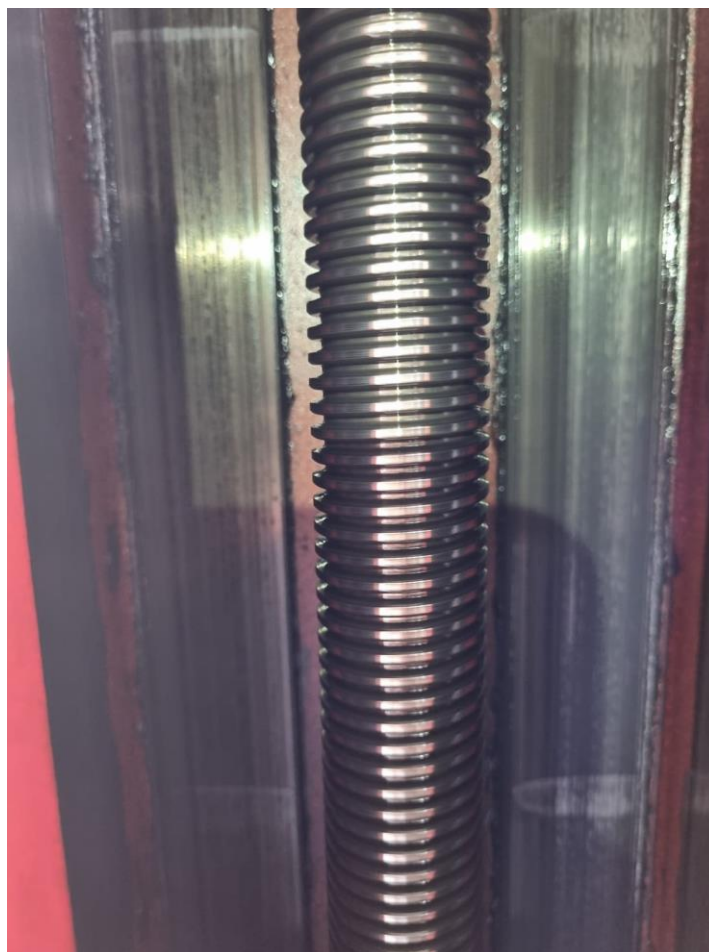
Figura 7 – Análise do fuso da coluna acionadora.
