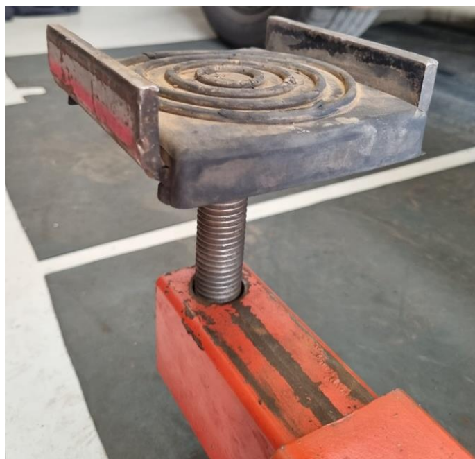
Figura 4 – Fixação do apoio do braço de elevação.
