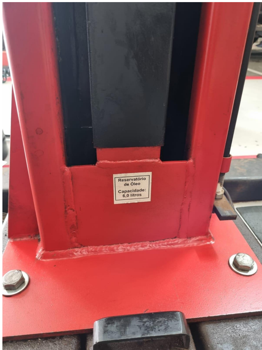
Figura 8 – Limpeza do reservatório de óleo.
