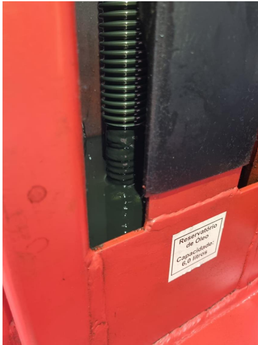
Figura 9 – Substituição e verificação do nível de óleo.
