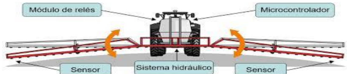
Figura 1 - Demonstração do sistema automático de controle de altura das barras do pulverizador agrícola Advance 2000 AM18.
