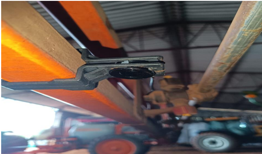
Figura 3 - Exemplo do Sensor ultrassônico instalado na estrutura da barra do pulverizador agrícola.
