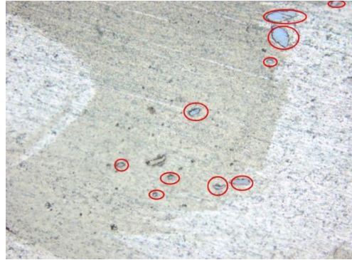
Figura 19 - Distribuição de cavacos de ferro fundido na matriz de alumínio - Amostra 1
