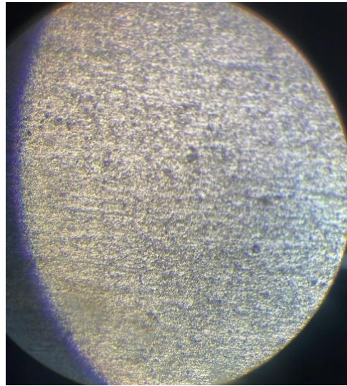
Figura 17: metal base após ataque com NaCl 3,5%
