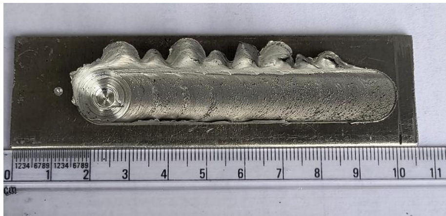
Figura 14 - Amostra modificada e sem defeito
