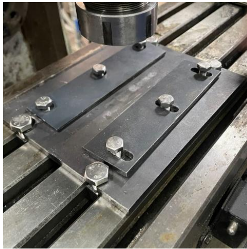
Figura 6 - Suporte montado e fixado na mesa da fresadora
