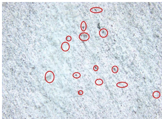
Figura 20 - Presença de cavacos de ferro fundido e microestrutura do compósito - Amostra 2
