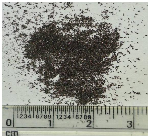
Figura 10 - Cavaco de ferro fundido
