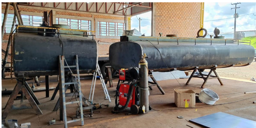
Figura 3 – Tanque original sendo redimensionado.
