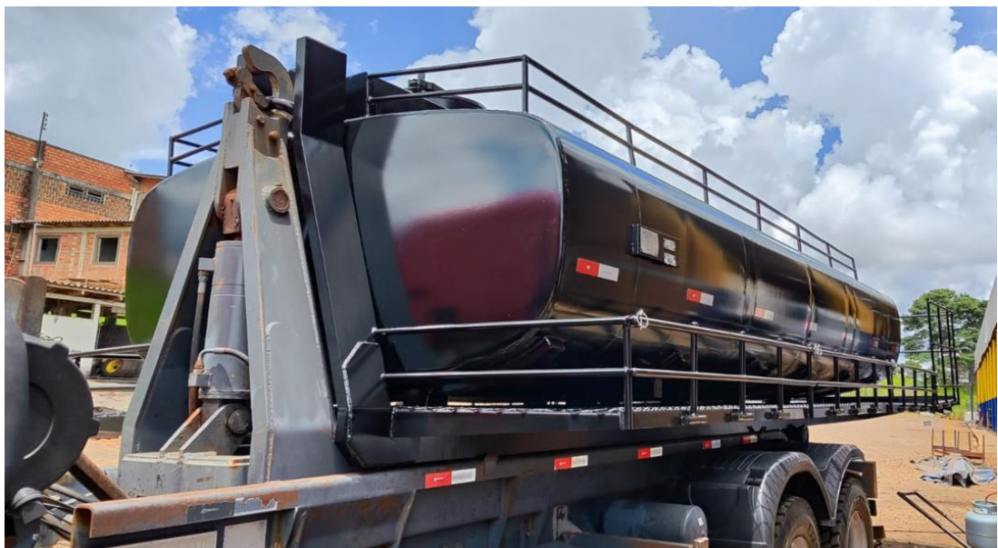
Figura 7 – Tanque finalizado, já reintegrado ao caminhão, destaque para o gancho de içamento frontal, demonstrado na Figura 3, em forma de projeto.
