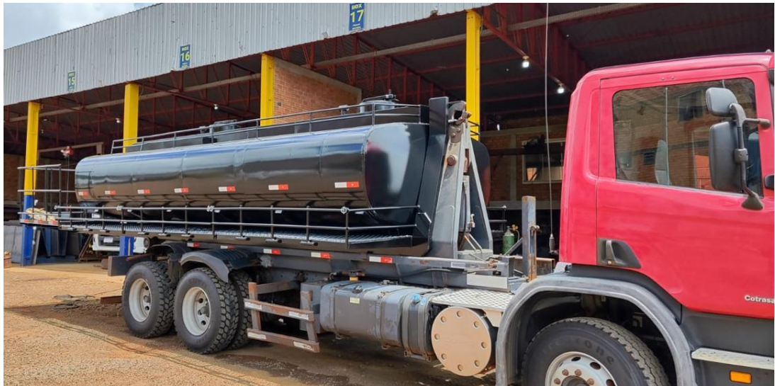
Figura 6 – Tanque finalizado, já reintegrado ao caminhão.
