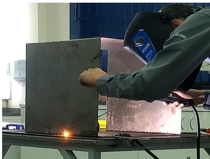
Figura 4 - Soldagem da caixa “forja”
