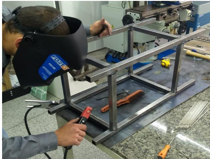
Figura 3 - Fabricação da estrutura de sustentação
