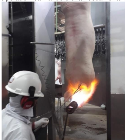
Figura 8. Operador realizando o chamuscamento da carcaça.
