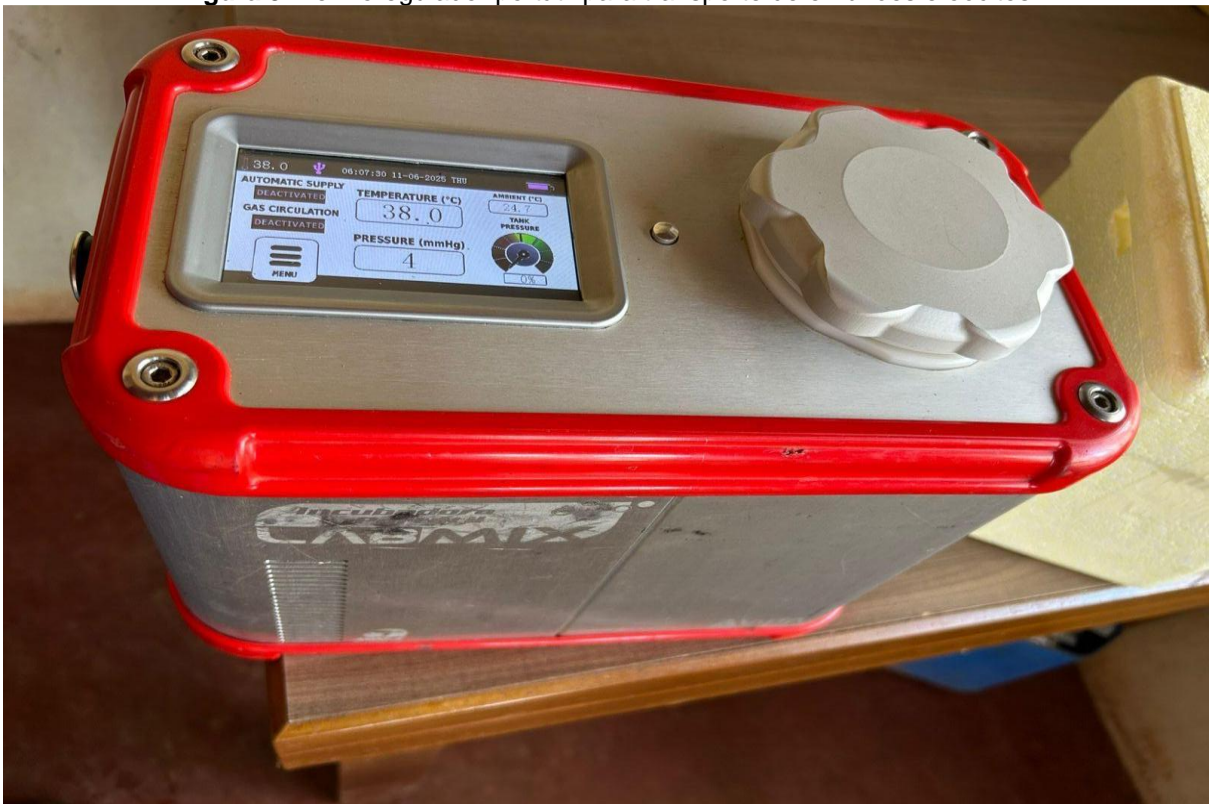
Figura 9. Termoregulador portátil para transporte de embriões e oócitos
