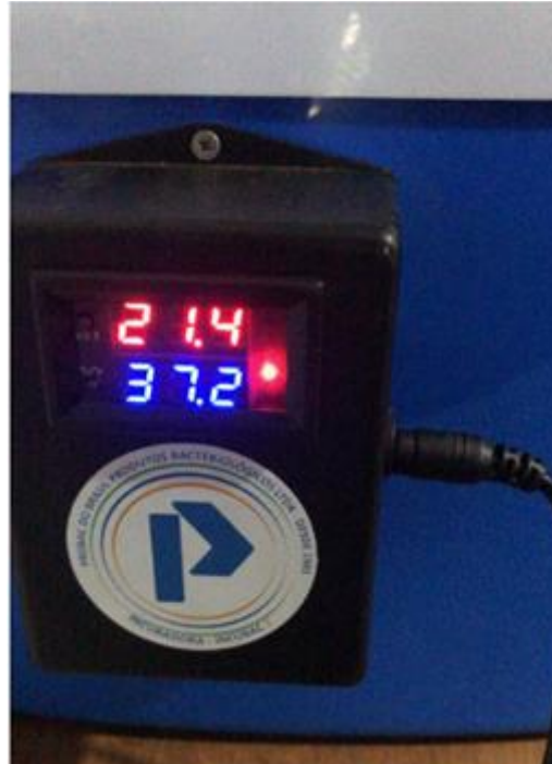
Figura 19. Termostato da estufa de crescimento bacteriano.
