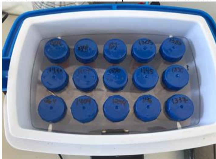
Figura 17. Estufa contendo os laminocultivos para o crescimento bacteriano.
